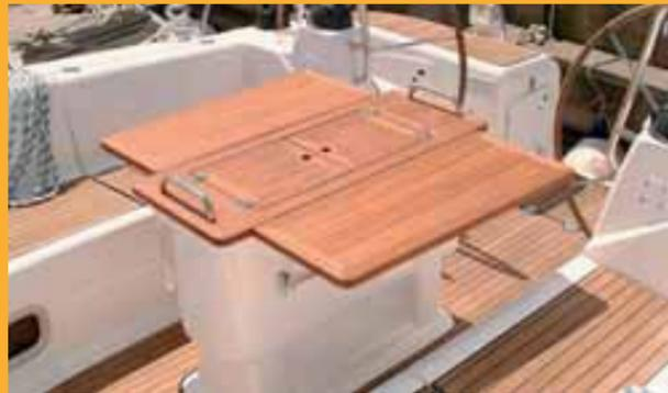
L'imponente tavolo presente in pozzetto con una struttura fissa, che comprende anche una pratica ghiacciaia. Sotto, la ruota timone di dritta
